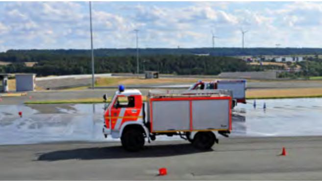
Bremsen auf trockener und auf nasser Fahrbahn im Vergleich.
